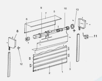
MAXIMUM WIDTH: 3500mm MAXIMUM HEIGHT: 2900mm MAXIMUM SQ METERS:12m WEIGHT SQ METER: 7.3kg
