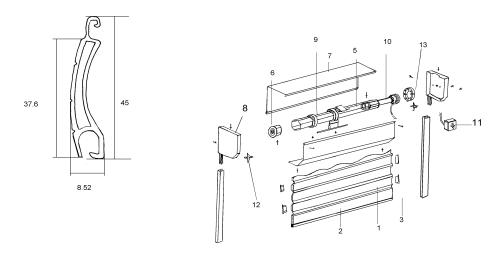
MAXIMUM WIDTH: 3500mm MAXIMUM HEIGHT: 2900mm MAXIMUM SQ METERS:12m WEIGHT SQ METER: 7.3kg
